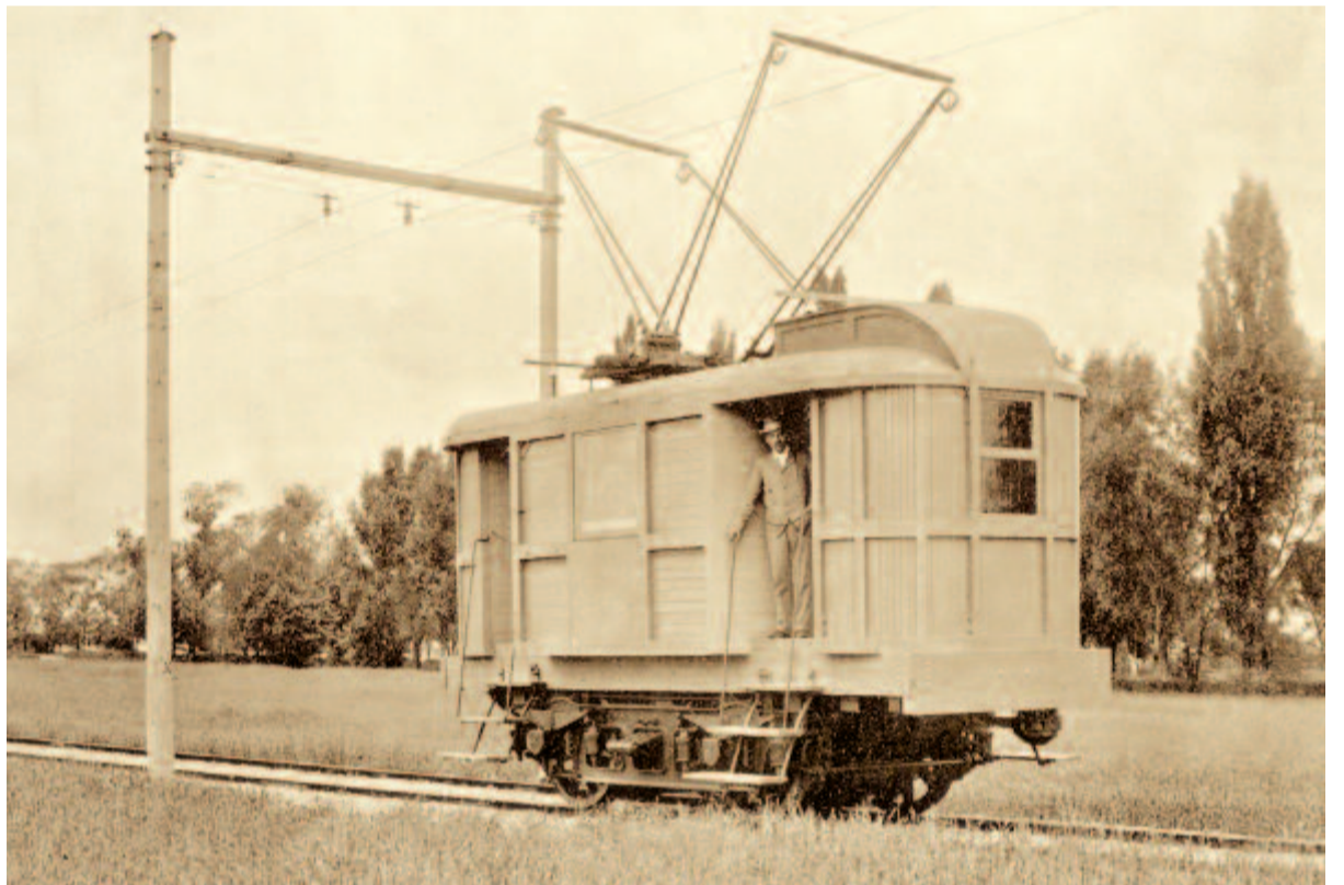
A Valtellina-mozdony fejlesztésekor épített kísérleti kocsia a Hajógyári-szigeten lefektetett próbapályán. (forrás: iho.hu)
